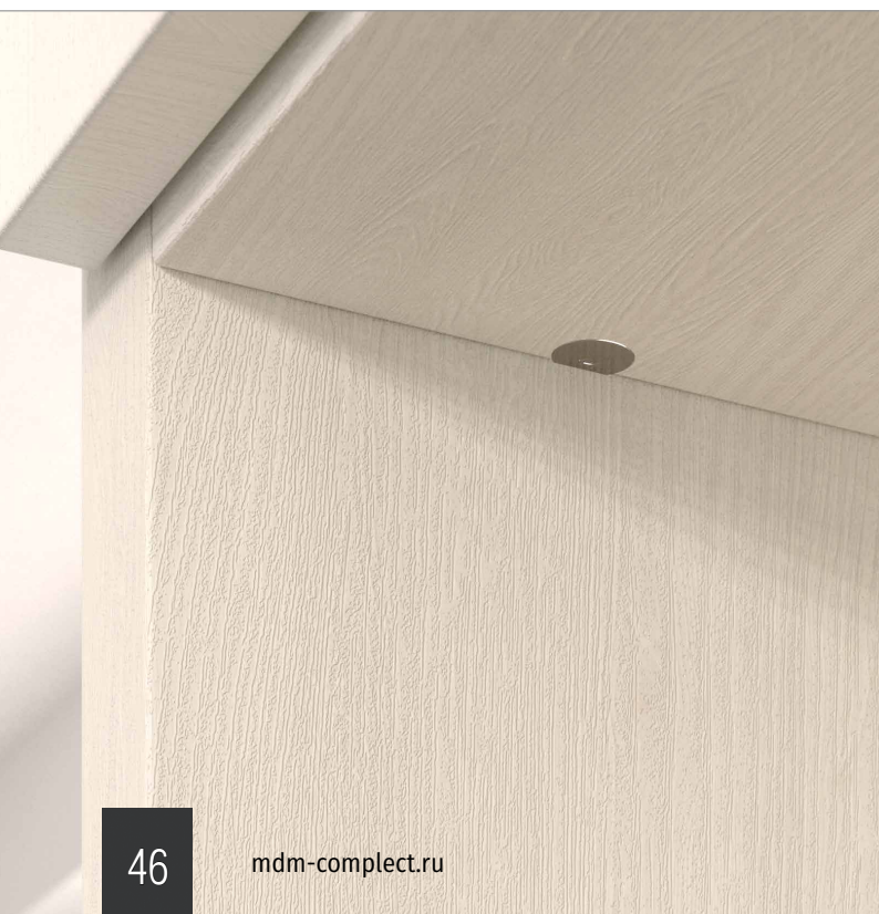
Вариант крепления полок (16 мм) к боковой стенке (12 мм) с помощью специального цилиндра с метрической резьбой М4
